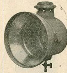
Petite face pour voiture et autos. — Corps d'une seule pièce, gaine plate rivée à l'arrière, cheminée d'une seule pièce rivée. Diamètre du pavillon 145 m/m longueur totale 130 m/m Tout cuivre poli.
